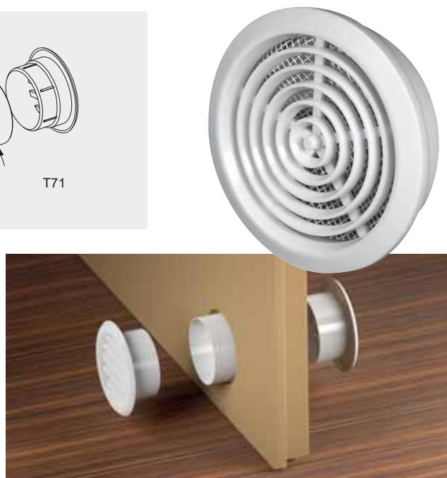
\* kratka T71 składa się z trzech części: wewnętrznej, zewnętrznej oraz łącznika. Minimalna grubość drzwi wynosi 37 mm
