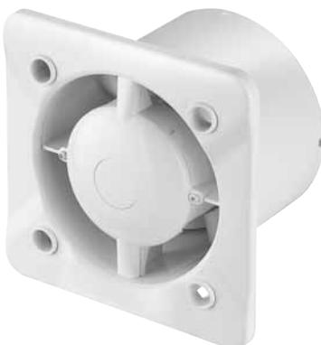
**Korpus wentylatora oferowany jest w rozmiarach Ø100 mm i Ø125 mm, w wersjach TURBO i SILENT. Wersja TURBO charakteryzuje się znacznie wyższym poziomem wydajności wymiany powietrza, a SILENT wyróżnia się bardzo niskim poziomem głośności (nawet 26 dB) i bardzo niską konsumpcją mocy, przy wystarczającej wydajności (95 oraz 145 m³/h w przypadku korpu-sów odpowiednio Ø100 i Ø125 mm).**
