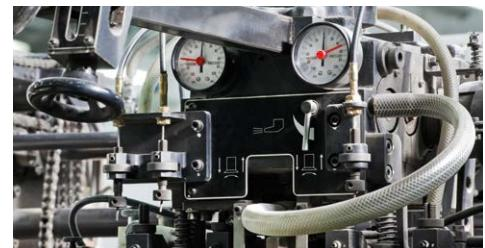
PL wąż PVC ze wzmacnieniem tekstylnym przeznaczony do przesyłu pod ciśnieniem środków ochrony roślin, powietrza, lekkich chemicznych i substancji spożywczych zgodnie z dyrektywą Reg. (EU) 10/2011 dla symulantów A-B-C zakres temperatur roboczych -10/+60°C nie zawiera ftalanów certyfikat bezpieczeństwa w wersji standard: wąż bezbarwny
