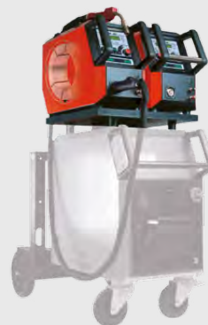
Dwa podajniki zewnętrzne (BB). Maksymalna mobilność w przypadku spawania dwoma średnicami drutu lub dwóch różnych materiałów.
