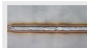
Spoina doczołowa. Stal CrNi, t=0,5 mm, bez odstępu.
