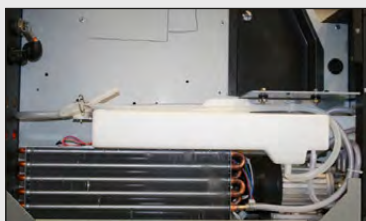
Standardowa chłodnica. Wydajność chłodzenia 1,1 kW.
