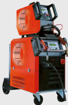
Dwa podajniki drutu (AB). Jeden w źródle, drugi zewnętrzny. Idealny przy częstym spawaniu dwoma średnicami drutu lub dwóch różnych materiałów. Zaoszczędzisz na dodatkowym osprzęcie.
